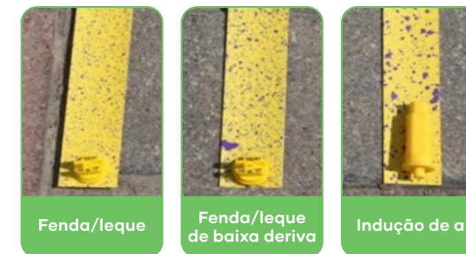
3 bicos diferentes, com o mesmo débito (l/m) na mesma pressão, mas com diferentes espectros de gotículas.
